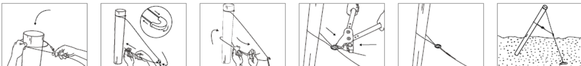
Haut : Câble de haubanage ceinturant le haut du piquet de tête Bas : Coulisse et Twister
